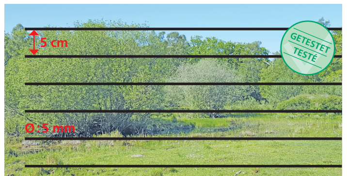
Abbildung 5: Markierungen mit vertikalen oder horizontalen schwarzen Linien sind bei transparenten Verglasungen wie Wind- oder Lärmschutzwänden, Passerellen oder Lifttürmen sehr effizient und stossen meist auf grosse Akzeptanz. Ist der Hintergrund oft eher dunkel, ist eine Ausführung mit weissen, orangen oder kristall- oder metallfarbenen Linien empfehlenswert. © Schweizerische Vogelwarte
